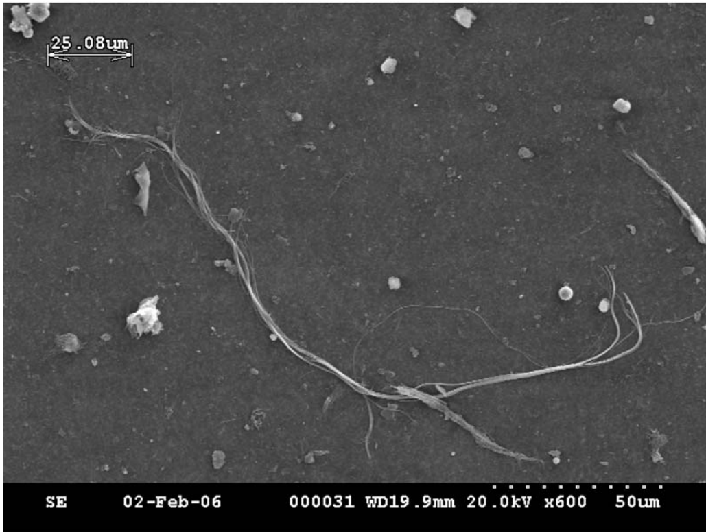
Rysunek 2.2 Zdjęcie z mikroskopu elektronowego, ukazujące włókna chryzotyłu
