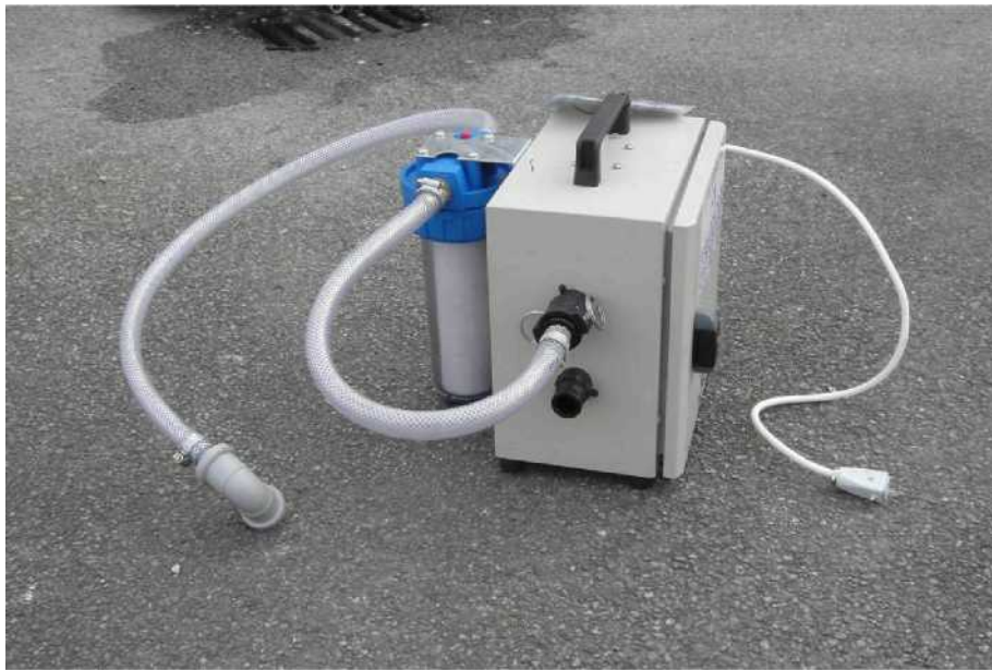
Rysunek 8.1 Filtrowanie wodą wypływ z bloku oczyszczania. Zdjęcie dostarczone przez UK HSE
